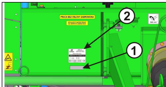
Rys.32 WIDOK NA TABLICZKĘ FIRMOWĄ I NUMER FABRYCZNY MASZINY
